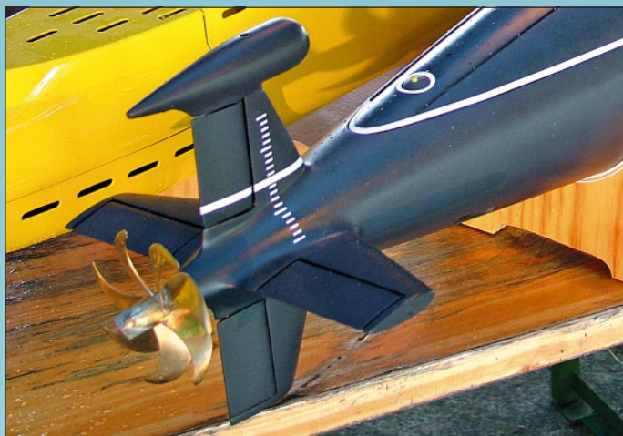
Detail zadních kormidel a nově zhotovená lodní vrtule s plechovým křížem na kuželu
