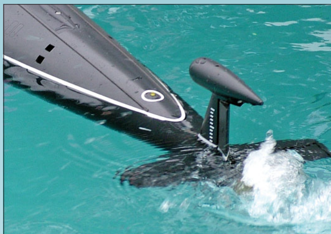
Už při mírně zvýšené rychlosti na hladině lodní vrtule nabírá vzduch
