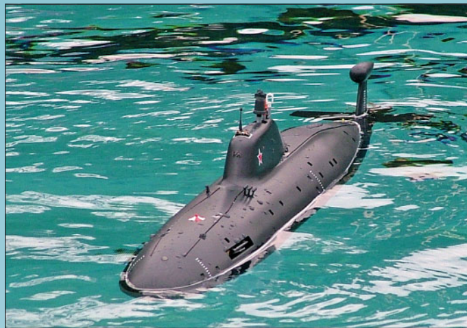
Výrazným prvkem Akul je vysoké zadní směrové kormidlo s gondolou, která z vody vystupuje až do úrovně věže.
